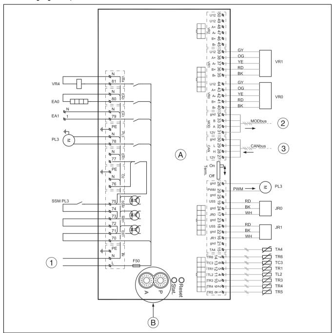
Fig. 25 Wiring diagram I/O module
