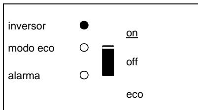
El inversor está encendido y suministra energía a la carga: Funcionamiento de la batería
