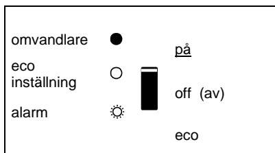
Omvandlaren slås på och levererar kraft till lasten.
