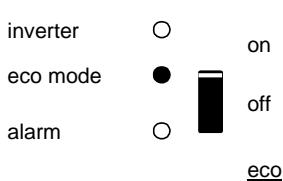
Der Wechselrichter arbeitet im „eco mode“
